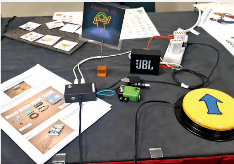
Abb. 4: Aufbau für Pausen-DJ mit selbstgebautem MP3-Player und Taster-Steuerung
